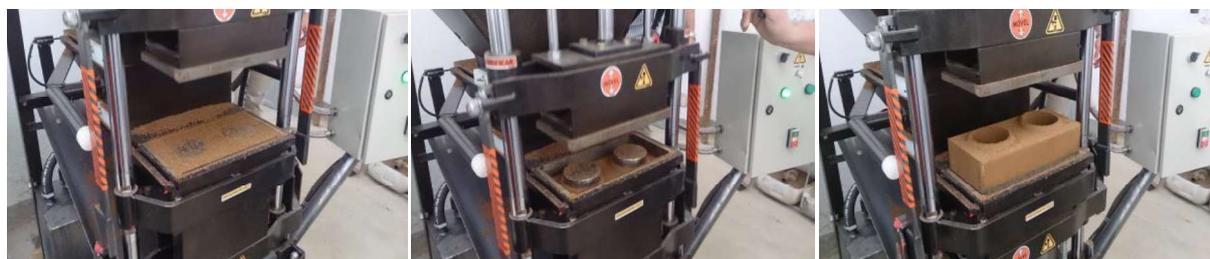
Figura 2. Sequência de confecção do tijolo na Prensa Hidráulica.
