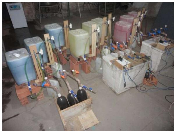
*Figura. 1: Biodigestores e respectivos gasômetros (Foto do autor).*
